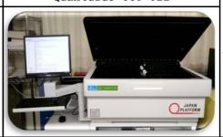
・低エネルギーのベータ線放出核種を 測定する機器
