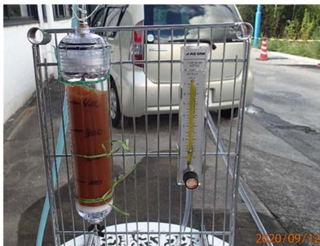
水道蛇口から直接、イオン交換樹脂カラム（円柱部：内径 54mm 長さ 220m）に上から通水し、フローメータで流量を調節しながら、ポリバケツで 10 リットルずつ受ける。10 リットルになったら隣のポリバケツにホースを移し、時間を記録し溜まった水の TDS（溶解固形量）を測定。
