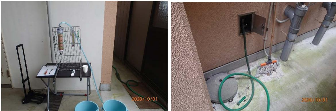
午前 10 時半から、フロートメータで流量を調節しながら、毎分 2 リットルで通水を開始。ポリバケツに 10 リットル貯まったところで、バケツを変えて、溜まった水の TDS（溶解固形量）を測定。途中、ホースの水漏れで若干中断しながら 11 時半に終了。
