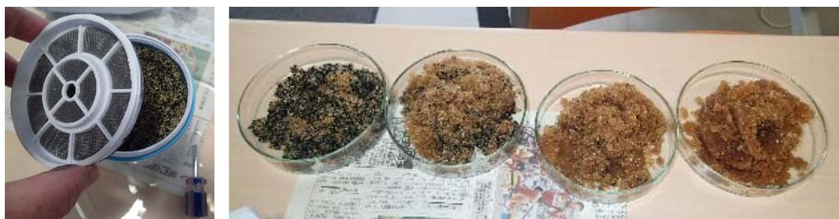
写真1. 左：カートリッジの蓋を取ったところ。右：上部から4分割したイオン交換樹脂。左から ZF2-1、ZF2-2、ZF2-3、ZF2-4。最上部の ZF2-1 にはチャコールが混じっている。
