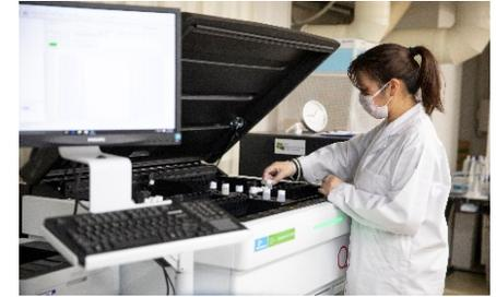
\* ベータ線 液体シンチレーションによる測定
