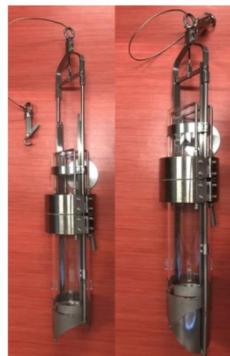
湖心の底層の水はバンドーン式採水器で採水。
