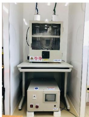
トリピュア(TRIPURE)トリチウム電解濃縮装置
