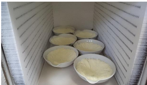
<電気炉にて灰化前>
