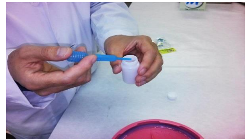
④発光剤と混ぜ、液体シンチレーションカウンタで放射能測定
