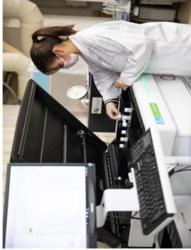
液体シンチレーションカウンタで測定
